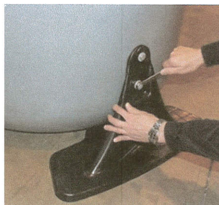
Obrázek 3.2. Přidělejte plastové stojny k tělu kontejneru pomocí šroubů.
