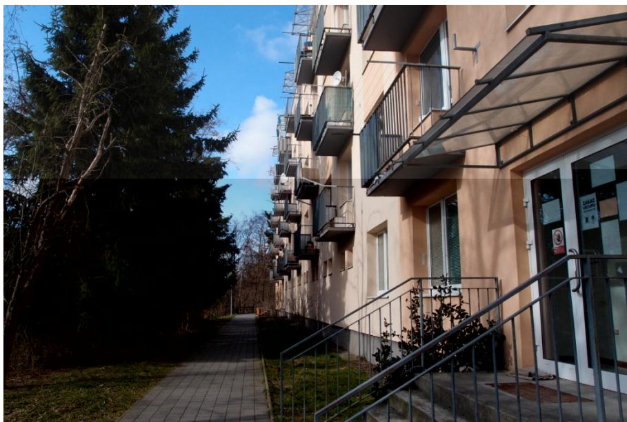
Obrázek 5: JZ orientovaná fasáda domu na ulici F. Hrubína je částečně zastíněna vzrostlými stromy. Ochrana oken vnějšími žaluziemi tak přichází v úvahu jen na části fasády.
