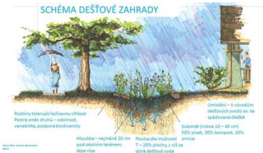
Schéma dešťové zahrady ( https://zena.aktualne.cz/schema-destove-zahrady/r~9782cbfee84f11e698c20025900fea04/ )
