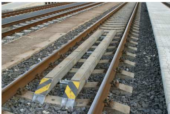
Obr. vlevo: traťová část automatického vedení vlaku (magnetický informační bod), foto: www.fscr.cz
