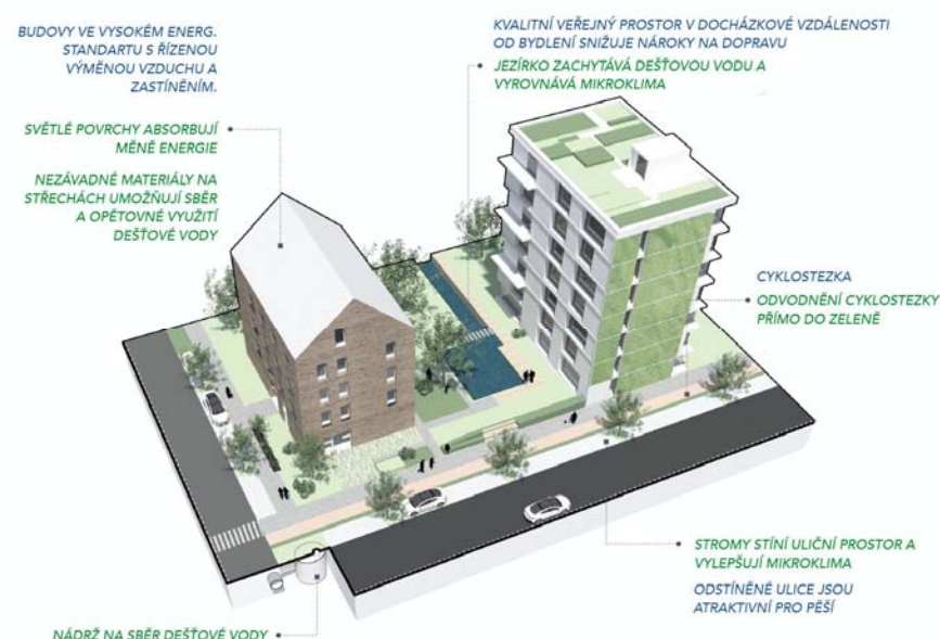
Obr. č. 2b: Ilustrace zastavěného území fungujícího dle principů zelené infrastruktury s efektivním hospodařením s dešťovou vodou a multifunkčním využitím veřejného prostoru (zdroj: www.zdravemesto.cz ).
