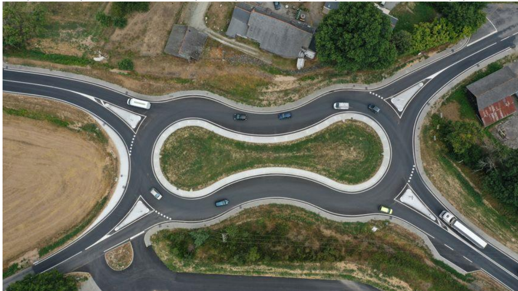
Obrázek Příklad možného řešení propojení odsazených křižovatek kruhovým objezdem
