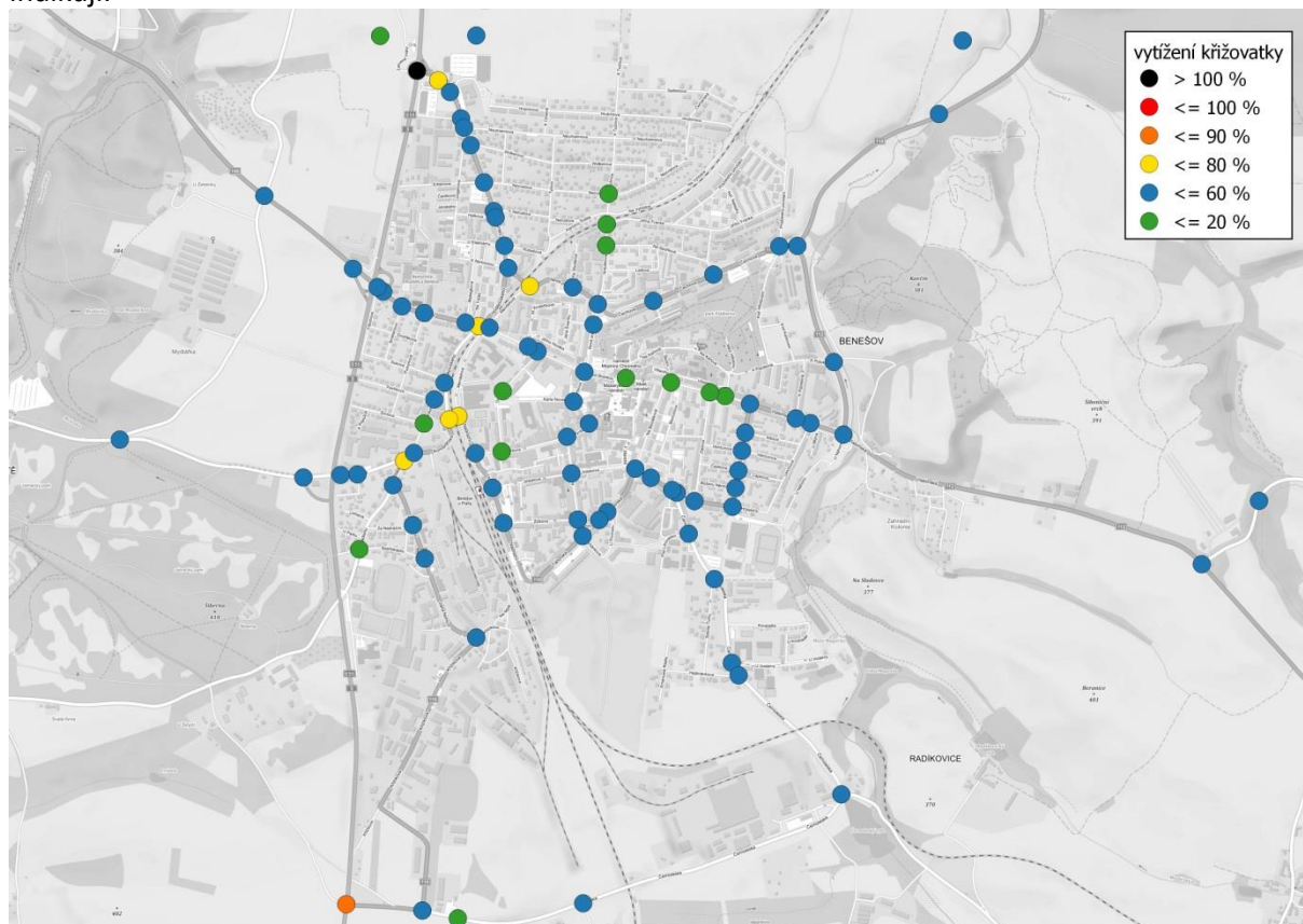
Obrázek 3 Vytížení křižovatek podle dolní meze kapacity v nulovém scénáři roku 2030
