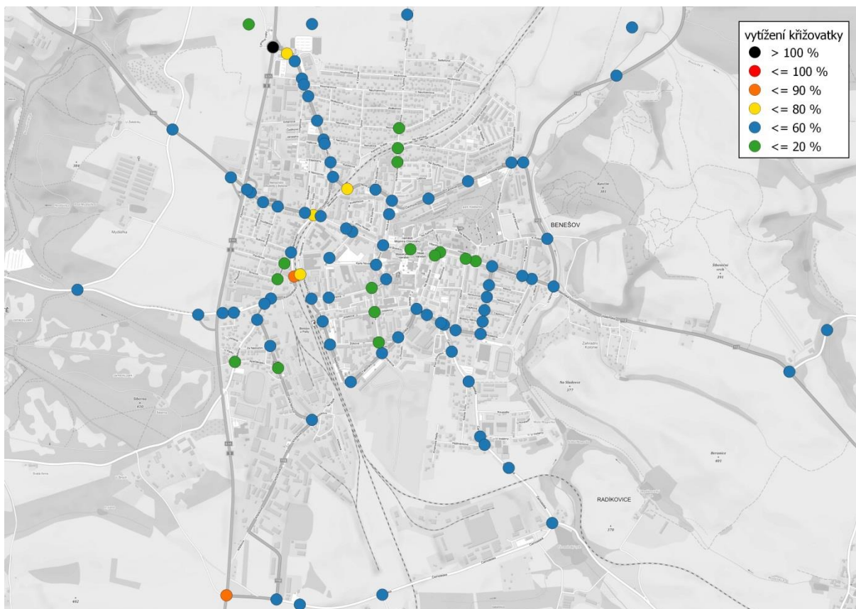
Obrázek 5 Vytížení křižovek podle dolní meze kapacity v návrhovém scénáři roku 2030
