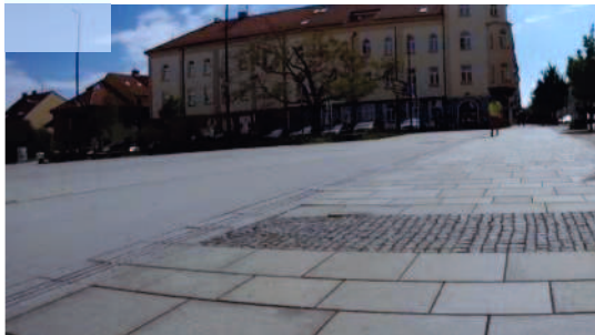
Bezbariérový chodník na náměstí T. G. Masaryka - signální pás přechodu pro chodce napojený na umělou vodící linii (pro osoby se zrakovým omezením).
