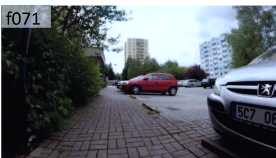
Bariérový úsek chodníku v ulici Kpt. Nálepky /do prostoru pohybu chodců na chodníku zasahuje vzrostlá zeleň a jeho průchozí šířku zužují parkující vozidla/.
