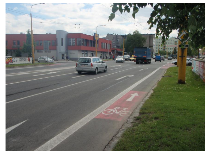
Vyhrazený jízdní pruh má sloužit k bezpečnému pohybu cyklisty v hlavním dopravním prostoru, ale i při průjezdu křižovatkou s vyšší intenzitou vozidel.
