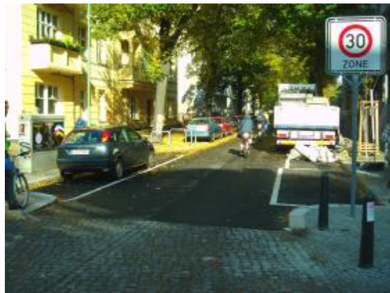
13 - Berlín, vjezd do zóny 30 řešen jako vjezd do obytné zóny – přejezdovým prahem s příčnou předností chodců (foto: Květoslav Syrový)
