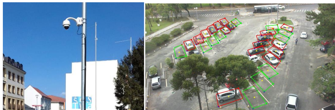
Obrázek 29 Detekce parkovacích míst pomocí dohledového systému
