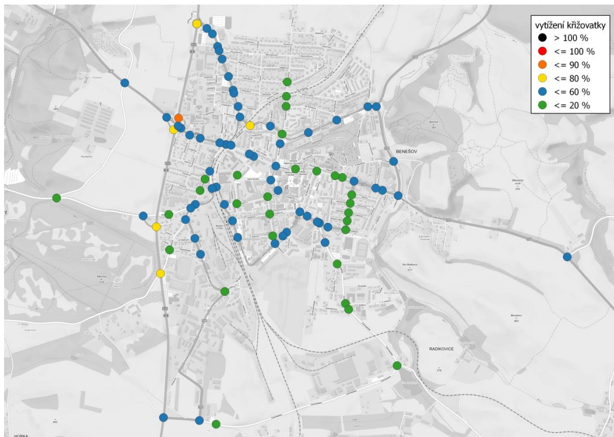
Obrázek 35 Vytížení křižovek podle horní meze kapacity
