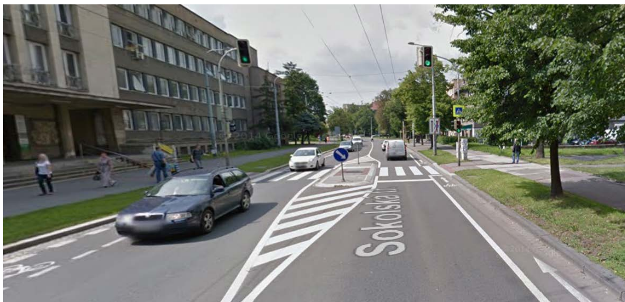
Obrázek 41 – Příklad správného řešení přechodu v ulici Poděbradova v Ostravě
