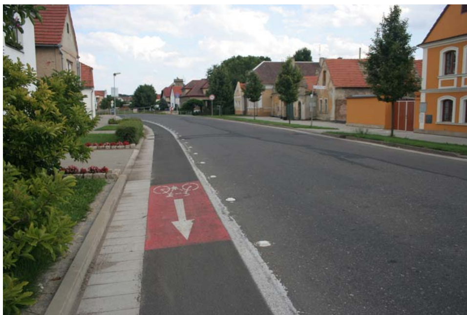
Obr. 17 - Jízdní pruh pro cyklisty oddělený dopravními knoflíky v Brozanech nad Ohří
