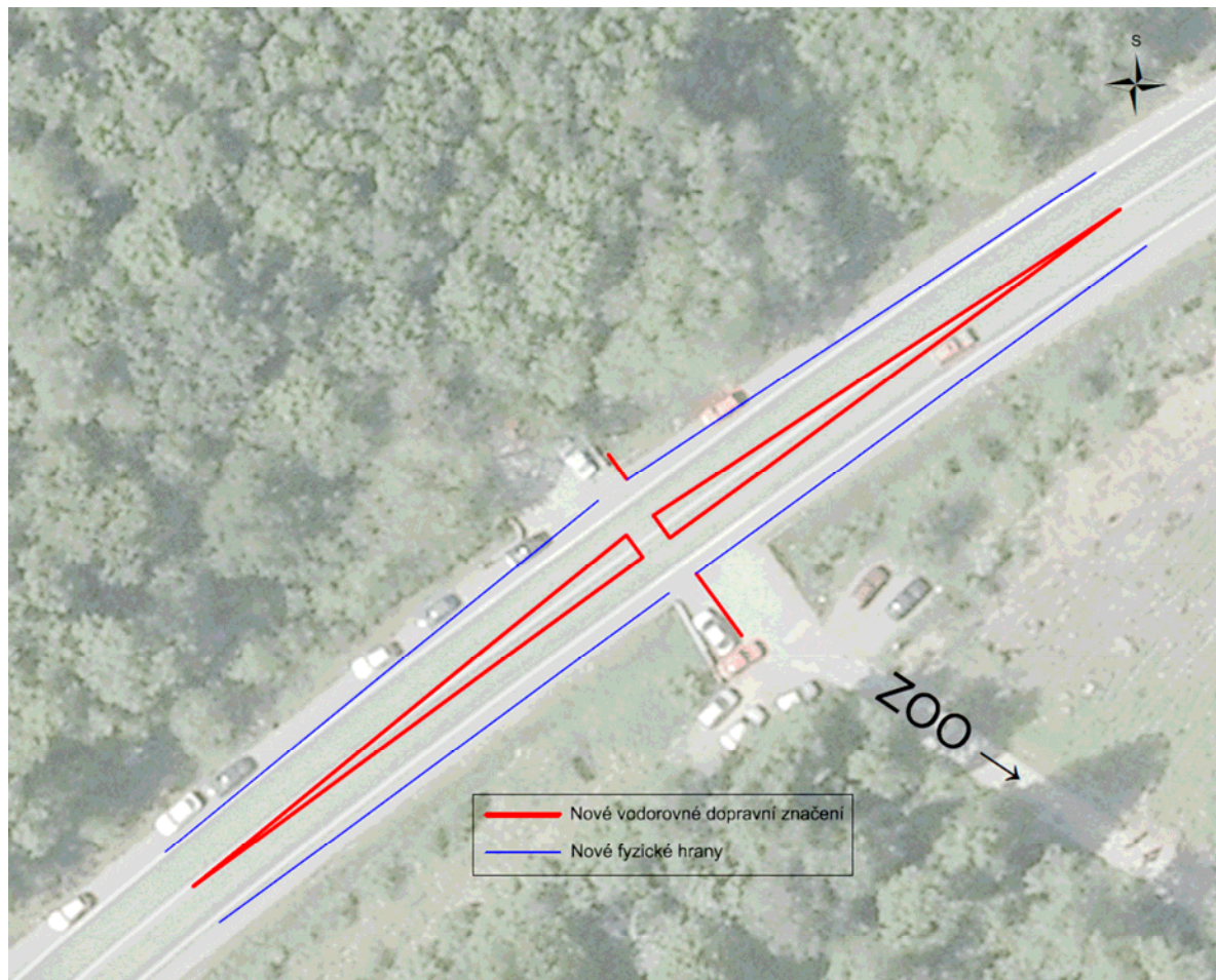
Obr. 38 - Vychýlení jízdních pruhů pomocí dělicího ostrůvku
