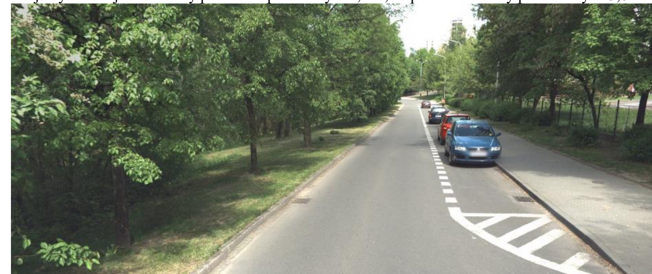
Obousměrný provoz na 5,8m široké vozovce místní komunikace ul.Okružní (údaj z pasportu MK)í, na níž je vyznačen jednostranný parkovací pruh šířky 2m, tzn, že pro obousměrný provoz zůstává 3,8m.
