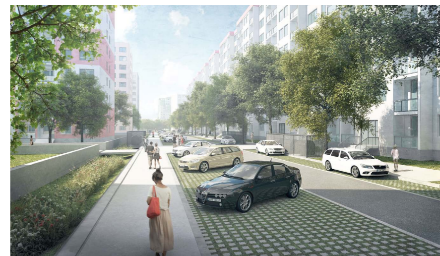
reference: projekt revitalizace Vybiralky, Černý most, návrh: IPR, příklad materiálově odlišeného parkovacího pásu v uličním profilu
