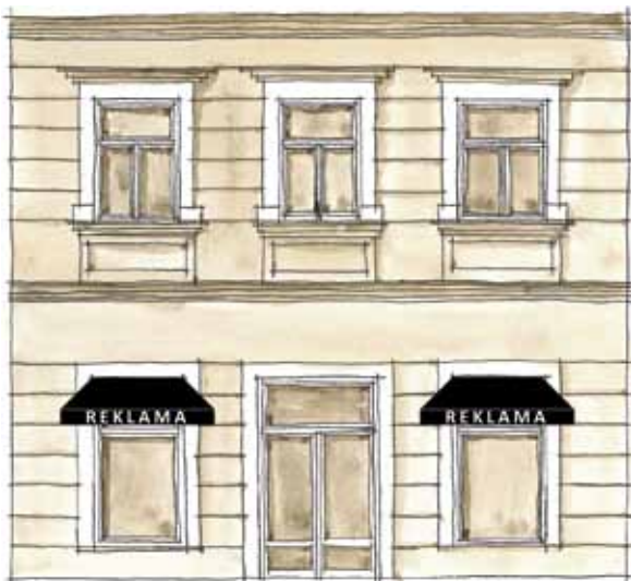
Obr. B103 | Vhodné maloplošné provedení markýz bez krycího boxu, vsazené mezi ostění, s reklamou pouze na volánu
