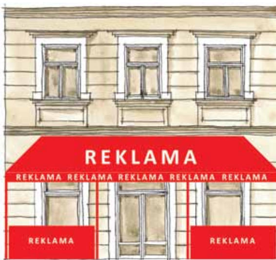
Obr. B104 | Nevhodný typ markýzy, velkoplošné provedení zakrývá fasádu, reklama v ploše i na volánu, svislé sloupky a výplně bočnic, markýzové boxy na fasádě
