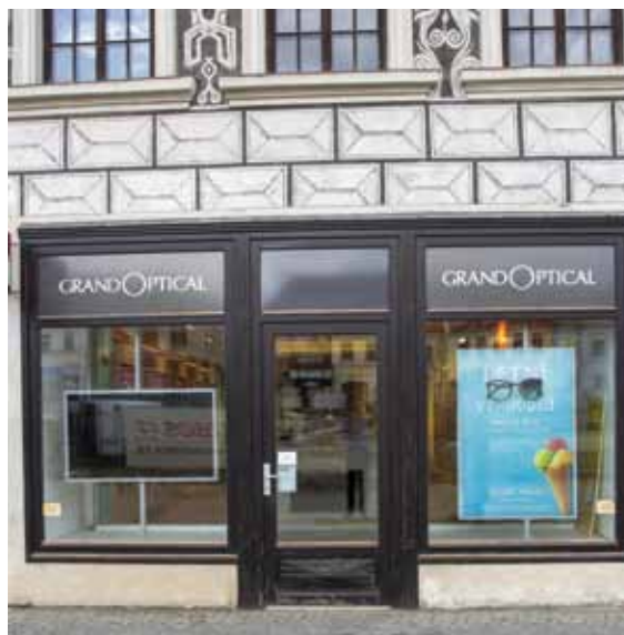
Polep, prezentační panel i obrazovka jsou přípustné, vhodnější je nápis z jednotlivých písmen a tlumená barevnost Obr. B042 | Třebíč
