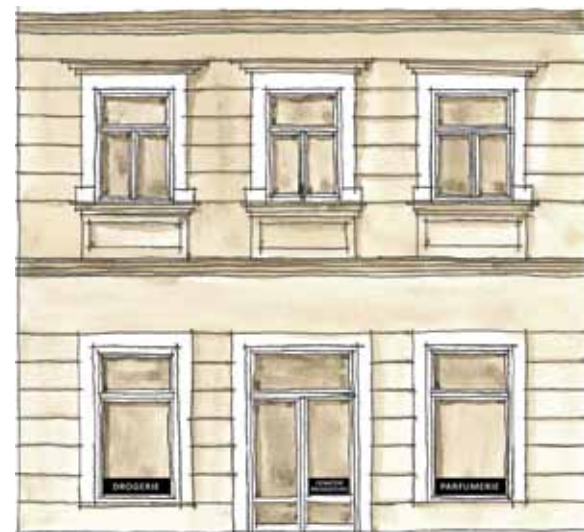
Obr. B038 / Polep výkladce ve formě vodorovných pásů mimo zorné pole zákazníka, lze užít i plošný polep z řezané grafiky, která zachová většinu prosklené plochy průhlednou
