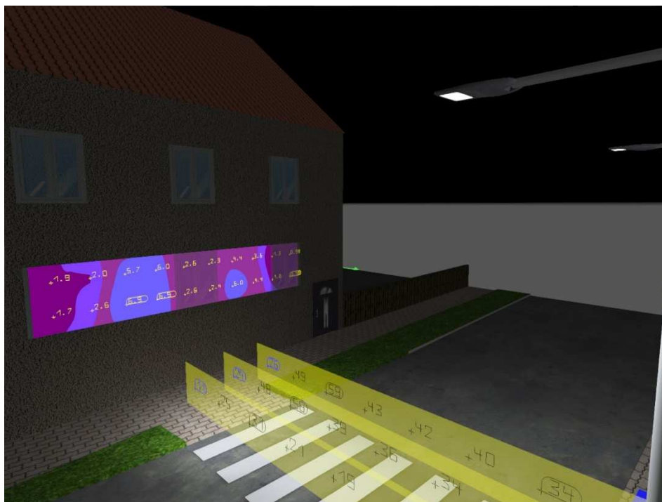
Obr. 74 – vizualizace hodnot E_v při přemístění svítidla B na stranu svítidla A ( E_{vmax}=6,9lx )
