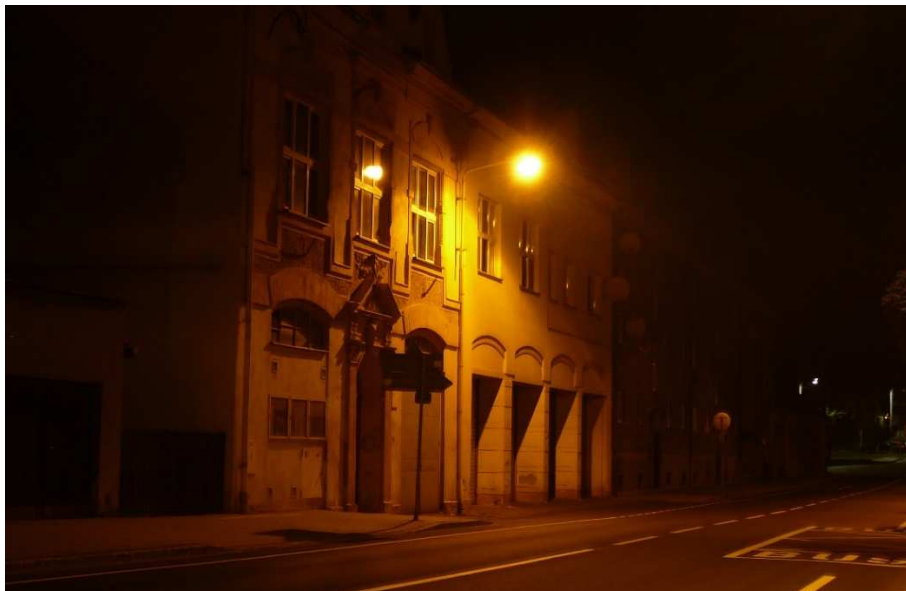
Obr. 76 - znázornění rušivého osvětlení na fasádě budovy – nevhodně umístěné svítidlo
