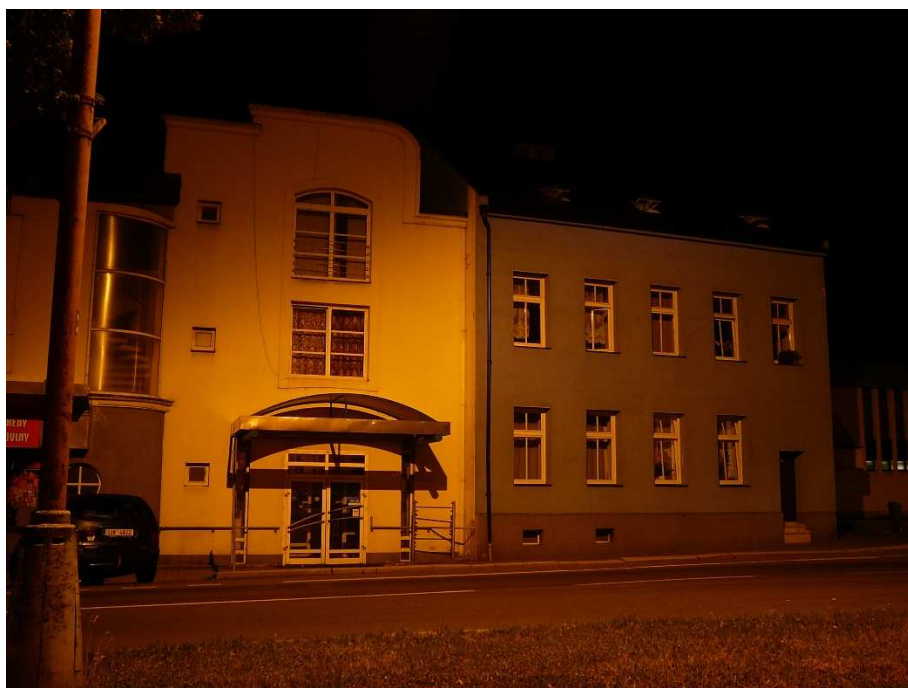
Obr. 77 - znázornění rušivého osvětlení na fasádě budovy – nekvalitní (zastaralý) optický systém
