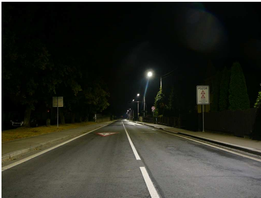
Obr. 78 – eliminace rušivého osvětlení LED technologií s kvalitním optickým systémem
