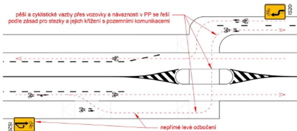
Obrázek 158: Příklad napojení stezky na vozovku s nutností zastavit, s využitím nepřímého levého odbočení dle TP 179
