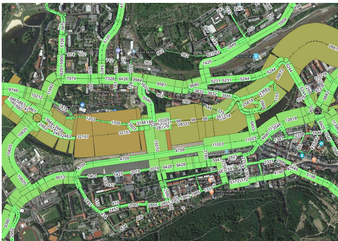
Obrázek 81: Model zatížení IAD ve vozidlech za 24 hodin, návrh C6/C4 UA soutěže, přemostění Charkovská
