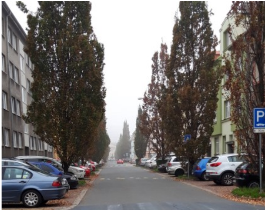
Obrázek 4 Příklad uličního profilu s oboustranným kolmým stáním a stromořadím Korunní Ostrava
