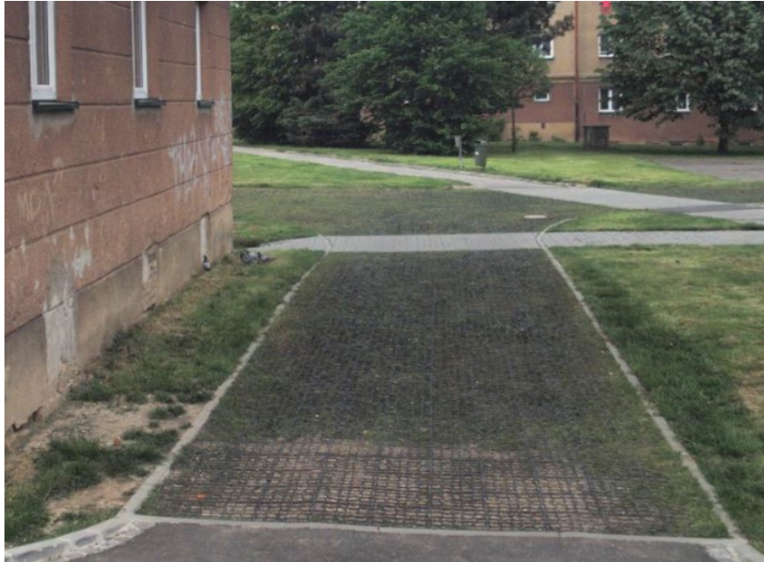
Obrázek 3 Příklad řešení parkování plastovými zatravněvacími rohožemi
