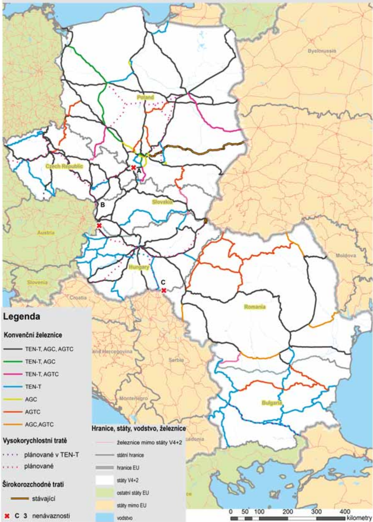
Vymezení železniční sítě podle její příslušnosti k mezinárodním dohodám na území států V4+2
