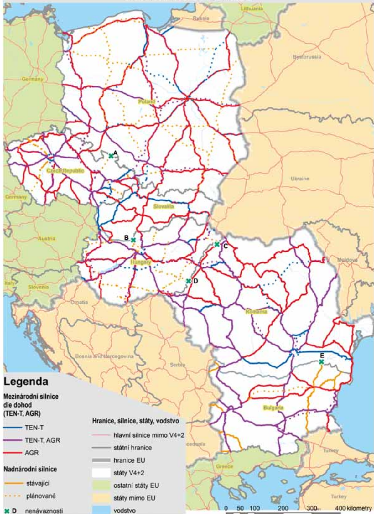
Vymezení silniční sítě podle její příslušnosti k mezinárodním dohodám na území států V4+2
