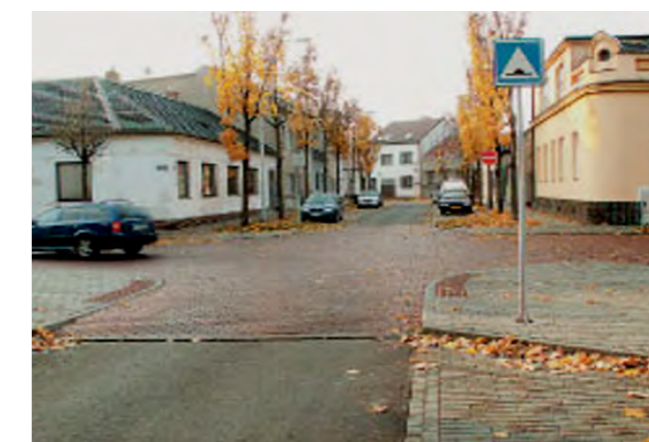
Obrázky: Příklady opatření zklidnění dopravy v zónách 30 – zpomalovací prah, zvýšená křižovatková plocha
