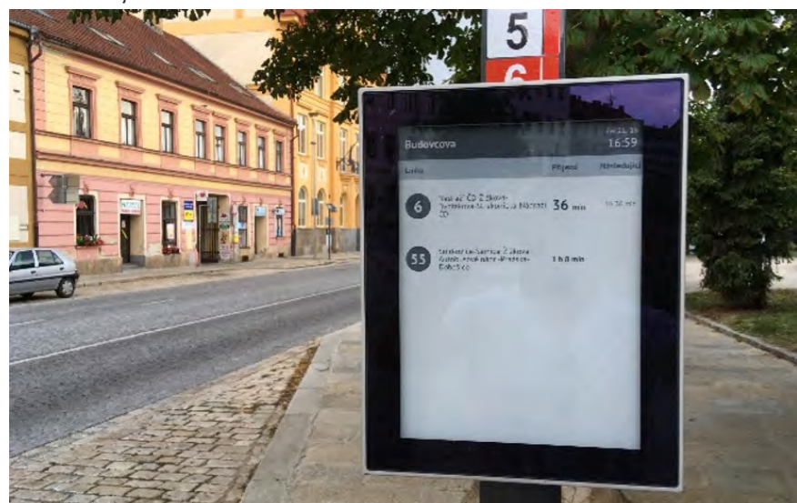
Obrázek: Technologie e-papíru použitá pro zobrazení odjezdů v reálném čase na zastávce s malým obrátem cestujících
