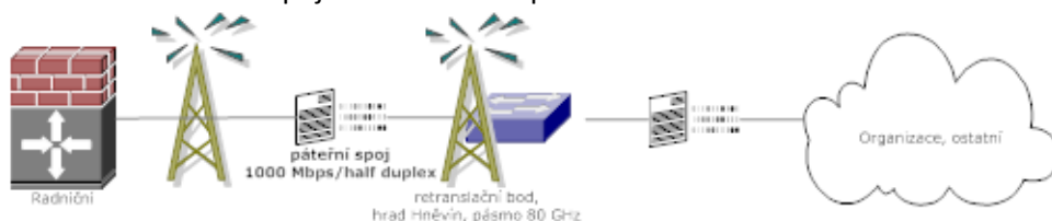
Obrázek 4 – Páteřní spoj v bezlicenčním pásmu 80 GHz
