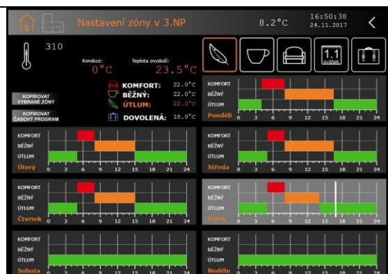
Využití inteligentního managementu v budově Městského úřadu Kroměříž - Individuální zónová regulace vytápění (zdroj: www.tecomat.cz ).
