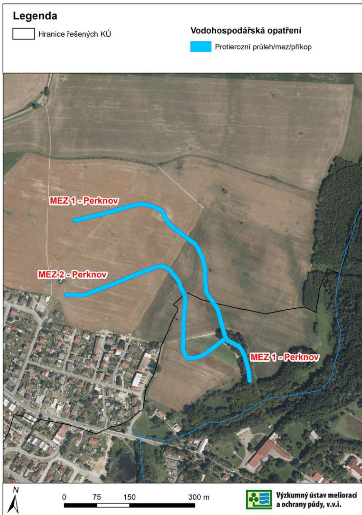
Obr. 120. Situace navržených mezí s příkopem v k.ú. Perknov
