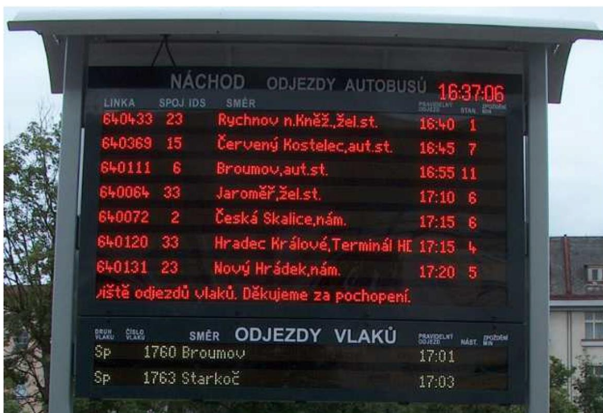
Obrázek 18 Kombinovaný zastávkový LED panel
