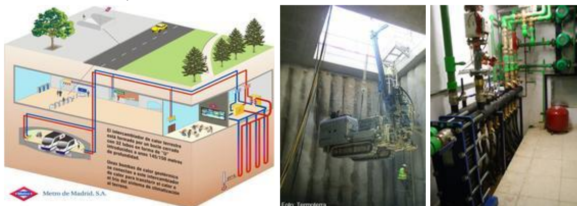
Obrázek 23: Schéma systému kolektorů; spouštění vrtací techniky do podzemí; technická místnost s oběhovými čerpadly, sběrači a rozdělovači smyček kolektorů
