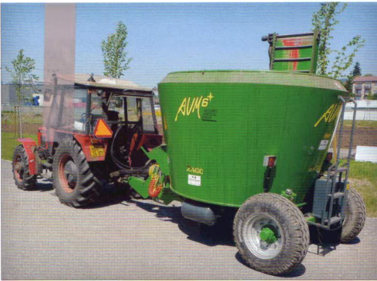
Promíchávání a homogenizace surovin – drtič biomasy ZAGO Antartes ECO 6 má objem pracovního prostoru 6 m 3 a výkonnost – asi 16 t/h, je vybaven pro provoz na pozemních komunikacích
