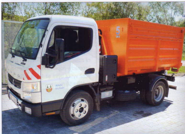
Svoz surovin – nákladní automobil FUSO CANTER 6S15 – jednoramenný nosič kontejnerů Charvát CTS a. s. Okřínek
