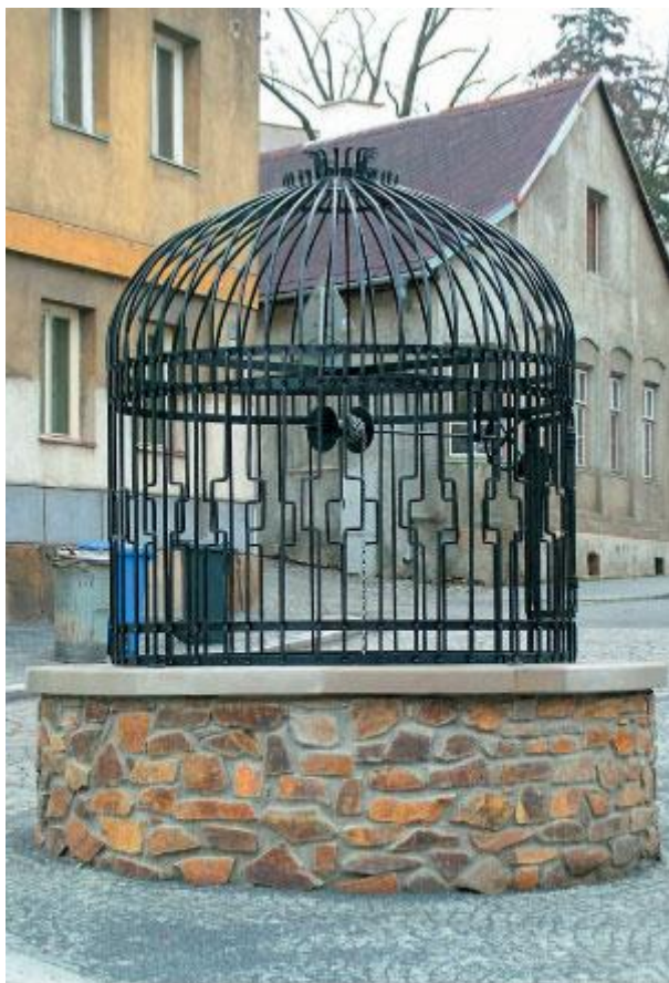
Zrekonstruovaná historická studna pomohla v centru Šternberka zúžit vozovku a v tomto místě zklidnit dopravu.
