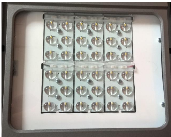
Obrázek 18 LED modul sestavený z LED opatřených vlastní čočkou, která vytváří celou čáru svítivosti (zdroj: vlastní)
