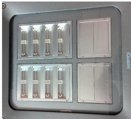
Obrázek 19 LED modul sestavený z LED, kde každá trojice LED čipů disponuje reflektorem a vytváří tak celou čáru svítivosti (zdroj: vlastní)
