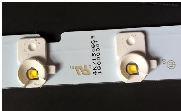
Obrázek 20 Detail optiky LED čipu. Vlevo reflektor, vpravo čočka (zdroj: vlastní)
