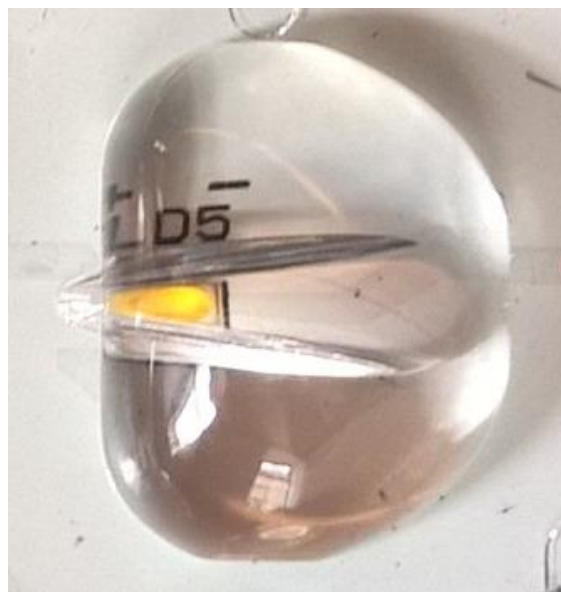
Obrázek 20 Detail optiky LED čipu. Vlevo reflektor, vpravo čočka (zdroj: vlastní)
